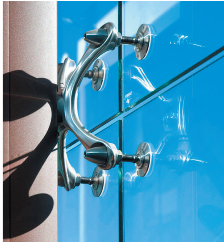
k292-X PSS AISI 304 k293-X PSS AISI 316 X-спайдер-300мм 4x26x38, 1x18x36/40мм Предельные эксплуатационные нагрузки Fx -6000 Н (600кг), Fy -2000 Н (200кг)
