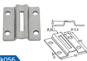
**k056** Бок. крепеж пластина под стойку  $\varnothing 38$ , вынос от стены 10мм, толщ. 3мм, сварка изнутри, без необх. зачищать шов
