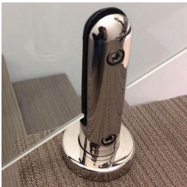
k277-3 оптимальное недорогое решение для крепления стеклянных панелей к бетонному основанию. Шпилька М16 обеспечивает надежное крепление стекла с четырехкратным запасом. Для осуществления регулировки в стеклах изготавливаются 30мм отверстия, в которые вставляются эксцентрики для исключения контакта торца стекла и шпильки. Задача эксцентриков поймать зазоры между соседними стеклами и скрыть неточности при сверлении бетона и допуски при изготовлении триплекса.
