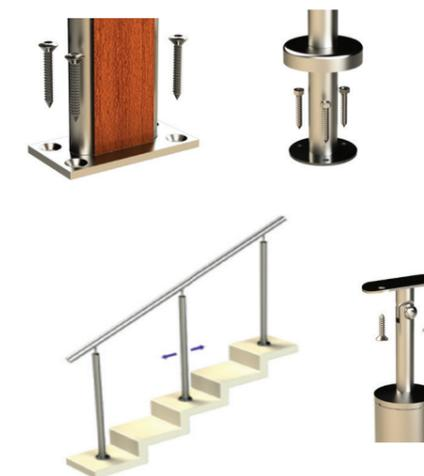
Распределите стойки через две ступени вдоль линии ограждения, сориентировав их так, чтобы держатели ригеля или крышки стеклодержателей были обращены на внутреннюю сторону марша. После этого закрепите первую и последнюю стойку на выбранный вами способ крепления и установите на них поручень. После монтажа поручня установите и закрепите остальные стойки согласно их распределению в местах контакта поручня и стойки.
