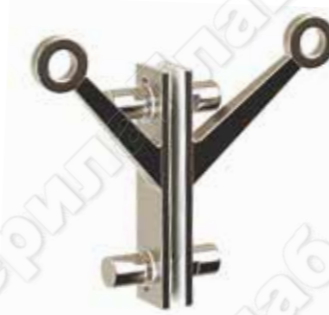
k290-V PSS AISI 304 k291-V PSS AISI 316 V-спайдер для установки на стеклянное ребро Предельные эксплуатационные нагрузки Fx -2500 Н (250кг), Fy -1500 Н (150кг)
